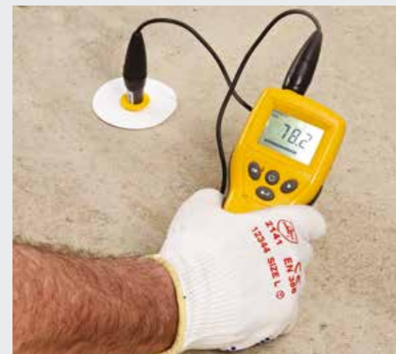
Mange fugtfølsomme natursten kan monteres, når fugtindholdet er nede på 80 % relativ fugt
